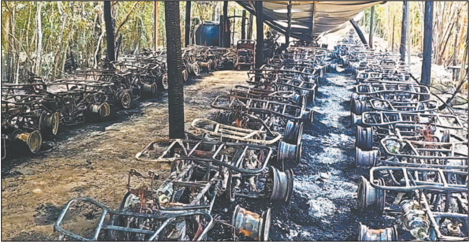
Se determinó que el fuego inició debido al sobrecalentamiento de un vehículo que permanecía energizado, pues la llave estaba activada. (A. Blanco)
