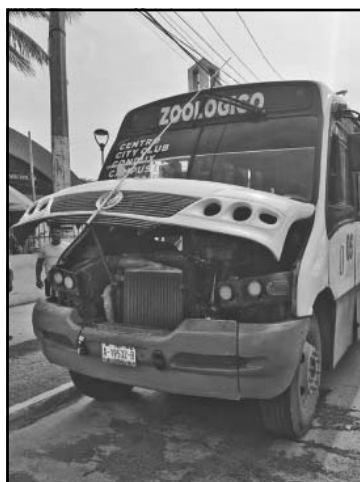
Al parecer un botón conectado, sobrecalentó el motor. (I. Lozano)
