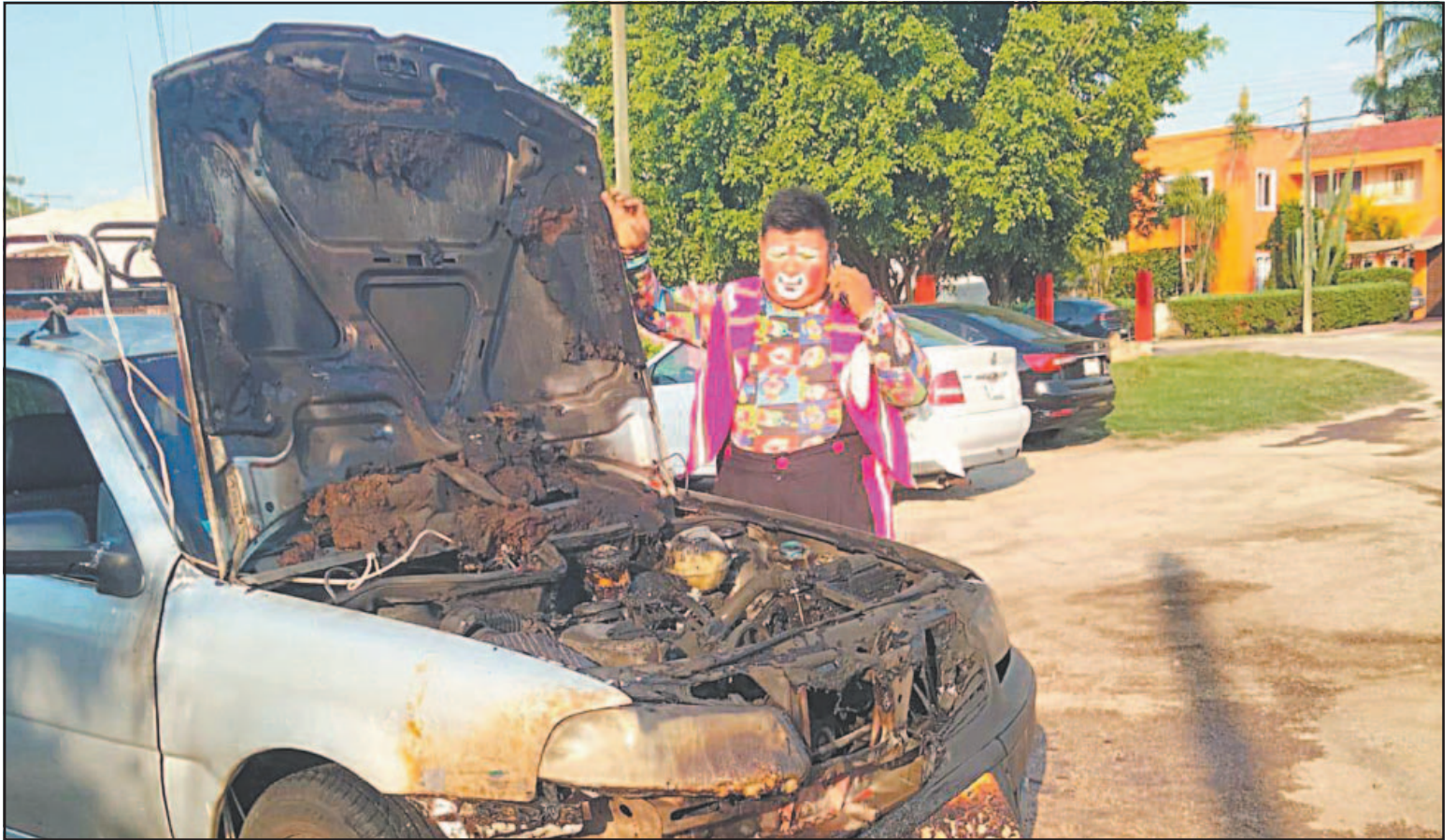
Versiones obtenidas en el sitio apuntan a una posible sobrecarga eléctrica, ya que usó la batería del auto para suministrarle luz a la bocina.
